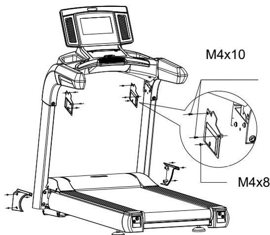
**Step V: Установка заглушек и провода питания:** установите 6 пластиковых заглушек (35), как показано на рисунке; подключите шнур питания в гнездо на передней части дорожки (во избежание травм, перед
