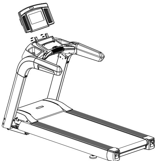
**Шаг IV: Установите декоративные элементы консоли и стоек:** Во-первых, закрепите левый и правый кожухи стоек (27 и 53) на беговой дорожке 6 винтами M8x8 с большой крестообразной плоской головкой; во-вторых, закрепите нижние крышки консоли (38 и 41) 2 винтами M4x8 (40) и 4 саморезами M4x10 с круглой головкой (39), как показано на рисунке ниже:
