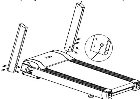
**Шаг II: Установка консоли.** Откройте коробку А и достаньте консоль. Соедините разъем провода на верхнем конце правой стойки с разъемом провода консоли, а затем вставьте левую и правую части поручней консоли в отверстия в вертикальных стойках. Не пережимайте провод, зафиксируйте консоль 6 винтами M18x16 (37) с шайбами (как показано на рисунке), затяните все винты шага 1 и 2:
