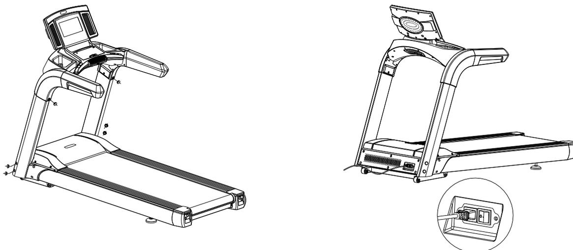
Шаг V: Завершите сборку беговой дорожки и проверьте затяжку всех креплений. Запустите беговую дорожку на низкой скорости и проверьте, гибко ли управляются различные части бегового полотна и правильно ли оно натянуто. Не допускаются смещение полотна от центра и его проскальзывание (см. «IX. Ежедневное обслуживание и уход за беговой дорожкой»). После проверки переместите беговую дорожку в нужное место и начинайте эксплуатацию.
