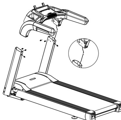
**Шаг III: Установка дисплея консоли:** Соедините разъем провода дисплея с разъемом провода консоли. Зафиксируйте с помощью 4 винтов с шестигранной головкой M6x25 (2) и шайб (3), как показано на следующем рисунке:
