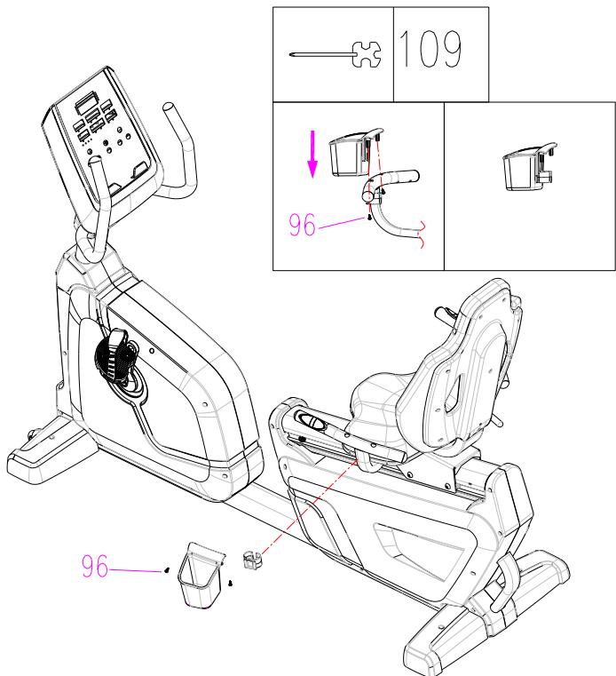
Установите держатель бутылки на руль и зафиксируйте при помощи винтов (96).
