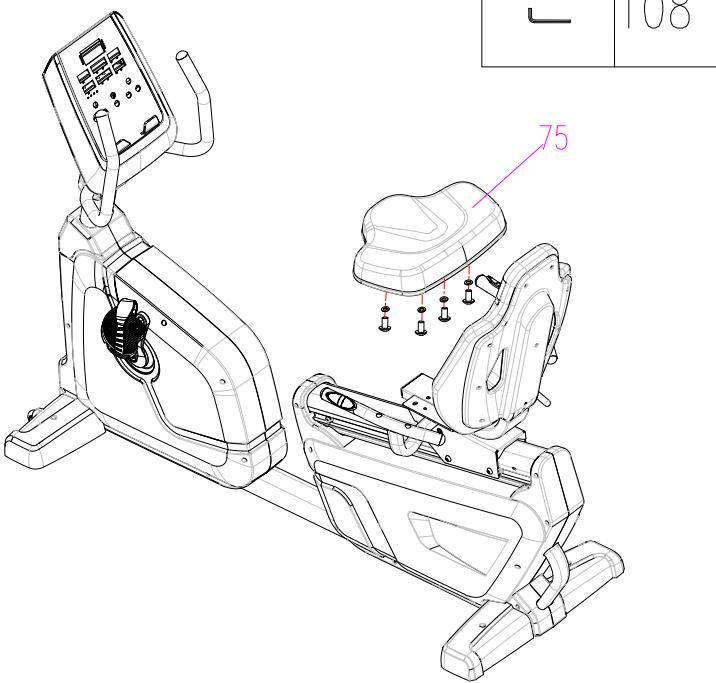
Установите сиденье (75) и зафиксируйте его предустановленными болтами.
