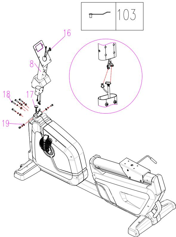
Соедините между собой кабель стойки консоли и кабель основания (17 и 16). Установите стойку консоли (8) на основную раму и закрепите при помощи болтов и шайб (18 и 19).
