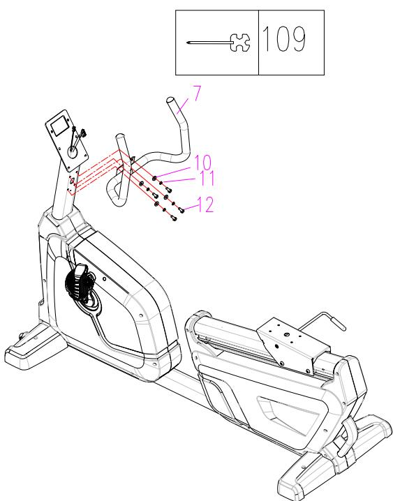
Установите руль (7) на стойку консоли и закрепите при помощи болтов и шайб (10, 11, 12).
