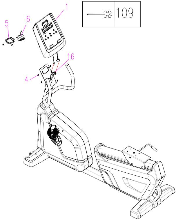
Установите батарейки (6) в отсек консоли (1) и закройте при помощи крышки (5).
