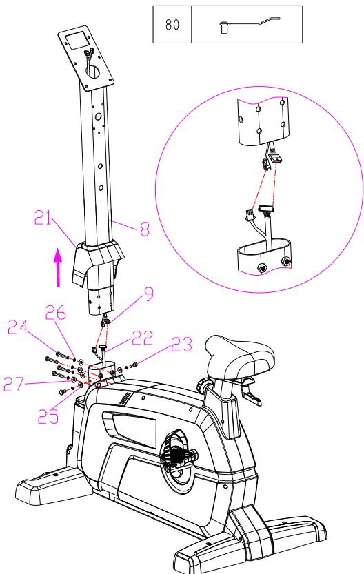
Соедините между собой кабель стойки консоли и кабель основания (9 и 22). Установите стойку консоли (8) на основную раму через кожух стойки консоли (21) и закрепите при помощи болтов и шайб (23, 24, 25, 26, 27), как показано на рисунке.
