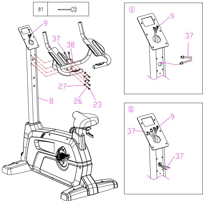
Проденьте кабели пульсомеров руля (37) через отверстие в стойке консоли (8) и выведите их вместе с кабелем стойки консоли (9), как показано на рисунке.
