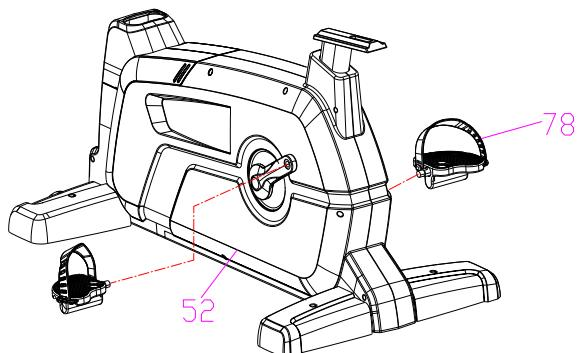
Откройте коробку и извлеките все составляющие части тренажера. Основание тренажера установите на ровную поверхность. Установите и закрепите передний и задний стабилизаторы. Прикрепите педали (78) к соответствующим шатунам.
