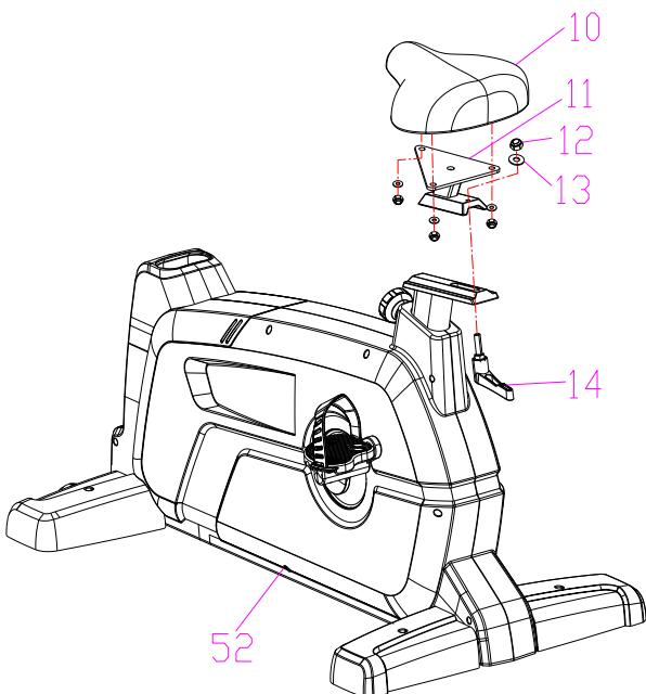
Установите крепление сиденья (11) на опору сиденья и закрепите их при помощи фиксатора (14).
