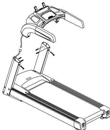
**Шаг III: Установите нижние декоративные крышки консоли.** Возьмите левую и правую нижние крышки консоли (72 и 3) и зафиксируйте их с помощью 4 саморезов с круглым поперечным срезом M4X10 и 2 саморезов Philips с большой плоской головкой M4X12, как показано на следующем рисунке:
