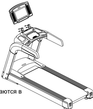
**Шаг V: Завершите сборку беговой дорожки и проверьте, затянуты ли различные части беговой дорожки.** Запустите беговую дорожку на низкой скорости и проверьте, гибко ли управляемятся различные части бегового полотна и правильно ли оно натянуто. Не допускаются смещение полотна центра и его проскальзывание (см. «IX. Ежедневное обслуживание и уход за беговой дорожкой»). После проверки переместите беговую дорожку в нужное место и начинайте эксплуатацию.
