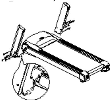
**Шаг II: Установите консоль.** Откройте упаковочную коробку беговой дорожки (коробка А) и достаньте консоль. Соедините разъем провода на верхнем конце левой стойки с разъемом провода консоли, а затем вставьте левую и правую части поручней консоли в отверстия в вертикальных стойках. Не пережимайте провод, зафиксируйте консоль 6 винтами M10×20 с полукруглой головкой (44) (как показано на рисунке) и затяните все винты шага 1 и 2, установите 10 заглушек (28).
